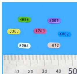
コードを印字した0.15mmのポリエチレンフィルムを貝類表面に接着剤で固定する外部標識です。8x4mmと16x8mmの長円形のもの、8mm径の円形のものがございます。印字文字はアルファベット・数字の組み合わせが可能です。
